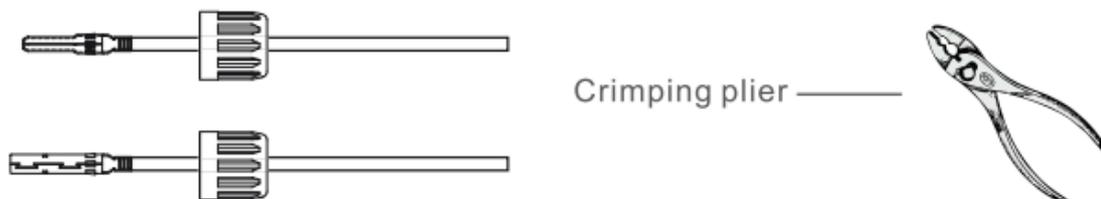
c) Inserte la clavija de contacto en la parte superior del conector y atornille la tuerca ciega en la parte superior del conector.
