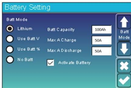
**Lithium:** Usar batería con cable de comunicación
