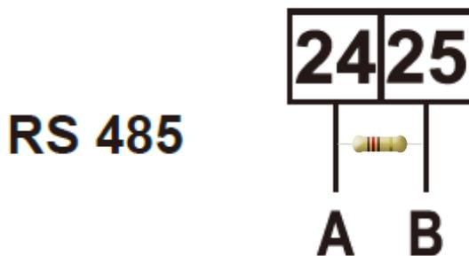
Es recomendable usar una resistencia de 120  $\Omega$  entre los cables RS485 A y RS485 B para evitar rebotes de señal
