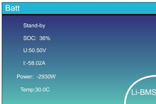
Detalles de la página de control de la Batería. Si se utilizan Baterías de Litio entrad en LI-BMS para configuración.
