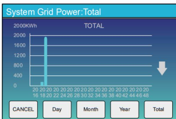
La curva de energía solar diaria, mensual y total se puede verificar aproximadamente en la pantalla LCD. Para una generación de energía más precisa, compruebe el sistema de monitoreo. Haga clic en flecha de abajo para verificar la curva de potencia de diferentes periodos.
