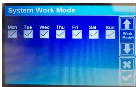
En la última pestaña del system work mode se pueden configurar los días en los que se desea que el sistema de trabajo funcione con la configuración establecida
