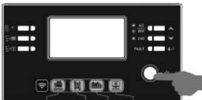
Una vez que la unidad se haya instalado correctamente y las baterías estén bien conectadas, simplemente presione el interruptor de encendido/apagado para encender la unidad.
