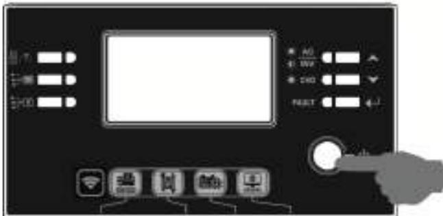
Paso 4. Asegúrese de seleccionar el tipo de batería como "SOL" en el programa LCD 5.
