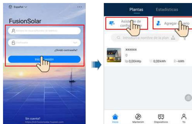
Figura 7-3 Creación de una planta FV y un usuario
