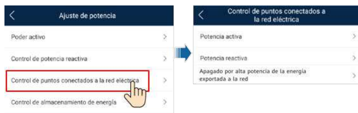
Figura 7-5 Control del punto de conexión a la red eléctrica
