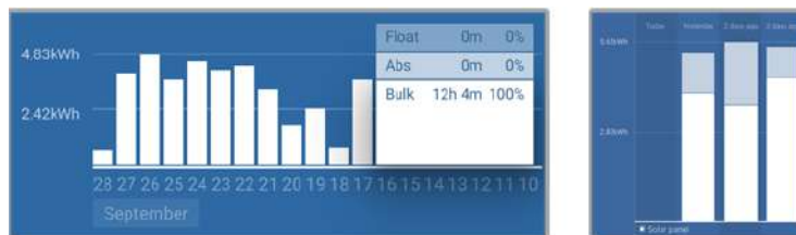
Izquierda: Ejemplo de un sistema que pasa todo el tiempo en la fase de carga inicial. Derecha: Desglose de las fases de carga - El sistema pasa tiempo en las fases de carga inicial y absorción.
