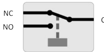
Funcionamiento interno del relé programable
