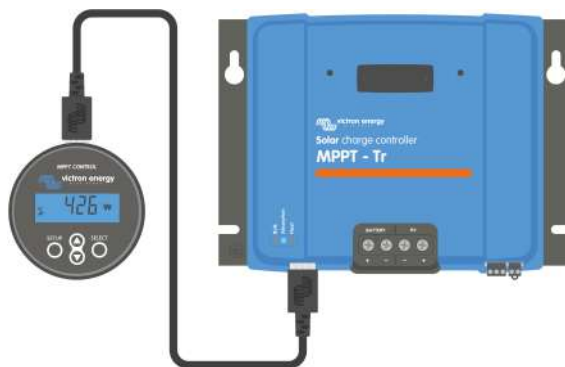
Conecte la pantalla al cargador solar con el cable VE.Direct.
