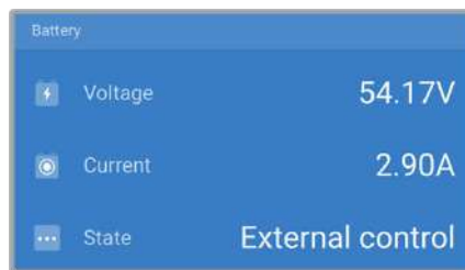
La aplicación VictronConnect indica que el cargador se controla externamente.
