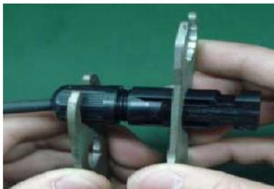
Paso 4: Verifique que la polaridad del cable de conexión de los módulos fotovoltaicos y los conectores de entrada fotovoltaica sea correcta. Luego, conecte el polo positivo (+) del cable de conexión al polo positivo (+) del conector de entrada fotovoltaica. Conecte el polo negativo (-) del cable de conexión al polo negativo (-) del conector de entrada fotovoltaica.
